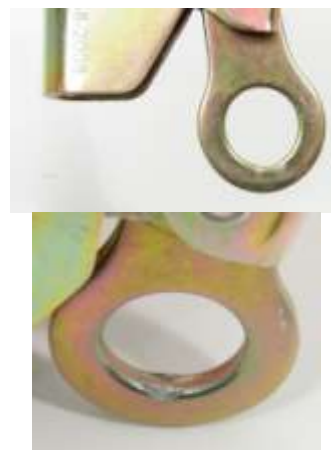
Рис. 50. Деформация проушины зажима в результате приложения нагрузки в момент остановки падения
