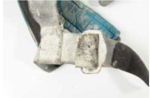
Рис. 15. Лента со следами воздействия химически активного вещества.
