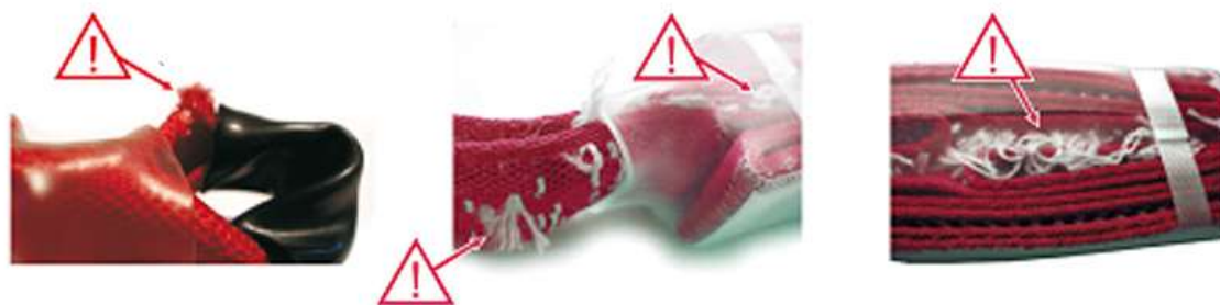
Рис. 28. Примеры амортизаторов со следами порезов ленты, надорванных нитей.
