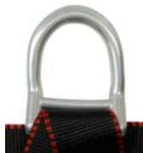
Рис. 21б. Деформированная страховочная точка на привязи после падения.
