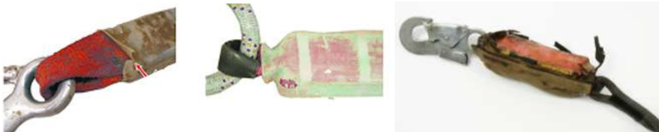
Рис. 54. Амортизаторы со следами дефектов защитных чехлов
