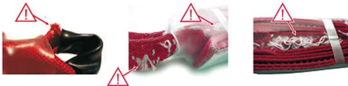
Рис. 53 Амортизаторы со следами дефектов
