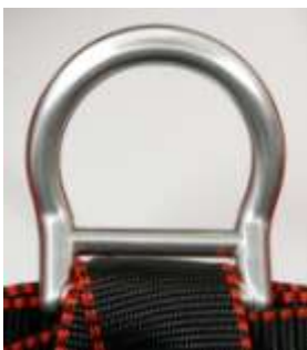
Рис. 21а. Новая страховочная точка до приложения нагрузки.
