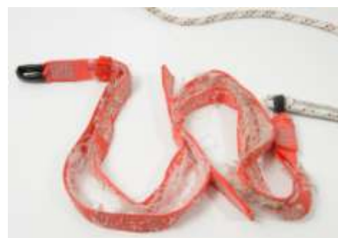
Рис. 52. Вид амортизатора после остановки падения
