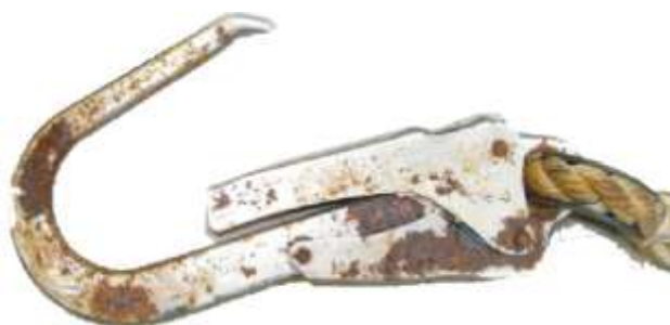
Рис. 31. Карабин, имеющий следы глубокой коррозии, а также отсутствующую пружину
