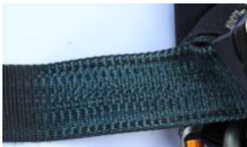
Рис. 10. Лента с участком, подвергшимся воздействию растворителя.
