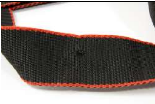
Рис. 7а. Пример ленты с выбившейся прядью
