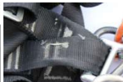
Рис.3. Проверка целостности индикатора срыва. Пример надорванного в результате падения индикатора срыва на привязи «Профи Мастер»
