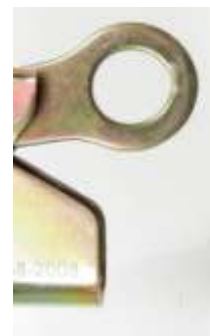
Рис.40. Деформация проушины регулировочного зажима
