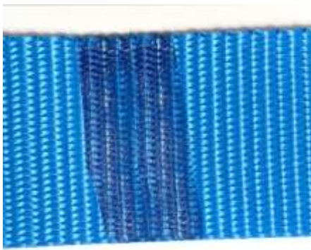
Рис. 12. Лента со следами ламинации (остекления волокон)
