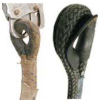
Рис. 38. Деформация коушей под воздействием нагрузки
