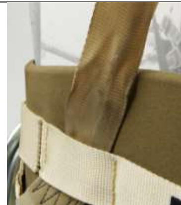
Рис. 9. Нарушение гибкости ленты в результате теплового воздействия
