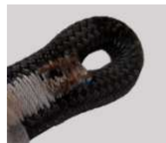
Рис. 46. Концевая зашивка с оплавлением
