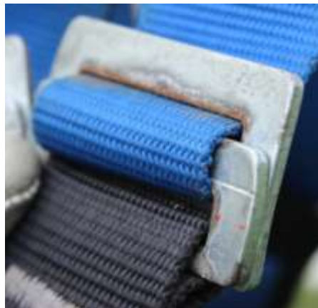
Рис. 18. Регулировочные пряжки со следами коррозии
