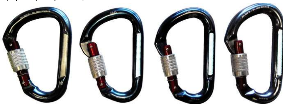
Рис. 65. Новый карабин и последовавшая под нагрузкой деформация.
