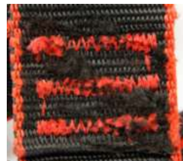
Рис. 17. Шов, подвергшийся тепловому повреждению
