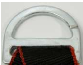
Рис. 22. Страховочная точка на привязи с трещиной
