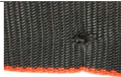
Рис. 7б. Пример ленты с выбившейся прядью (увеличенное изображение)
