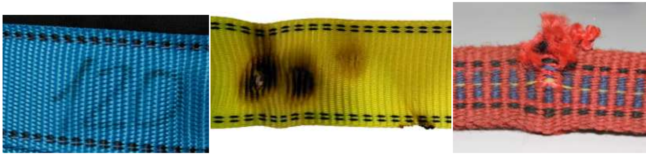
Рис. 32. Примеры лент с различными повреждениями: химическое, тепловое, механическое повреждения.
