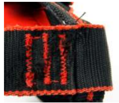
Рис. 16. Шов, подвергшийся механическому повреждению
