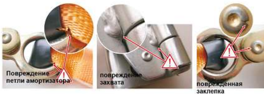
Рис. 51. Примеры возможных дефектов зажимов ползункового типа.
