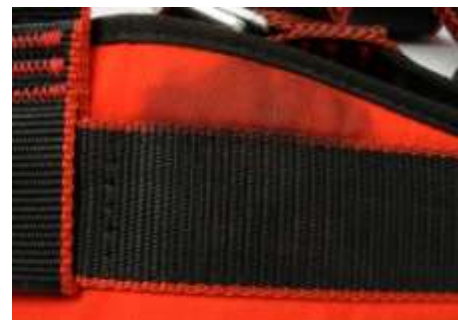
Рис. 11. Масляное пятно на накладке и ленте. На ленте присутствует очаговое изменение цвета и структуры.
