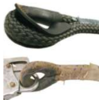
Рис. 48. Отсутствующие или поврежденные защитные чехлы на силовых швах
