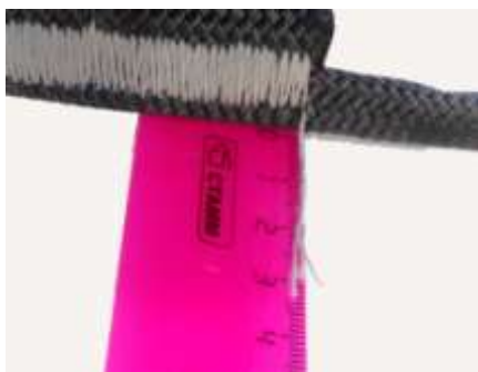
Рис. 47. Максимально допустимая длина выбившейся нити.
