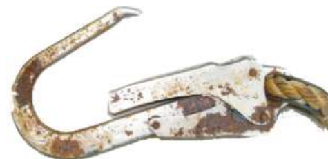
Рис. 61. Карабин, имеющий следы глубокой коррозии, а также неисправный запирающий механизм
