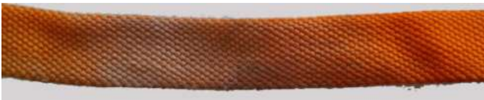
Рис. 33. Лента с выцветшими участками под воздействием УФ-излучения.
