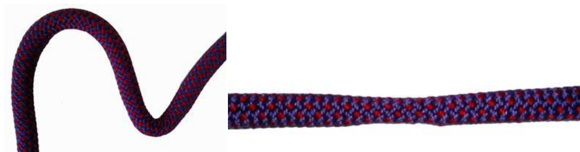
Рис. 35. Канат с участком, имеющим более тонкий диаметр, а также меньший радиус сгиба.
