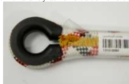
Рис. 45. Концевая зашивка с порезанными нитями
