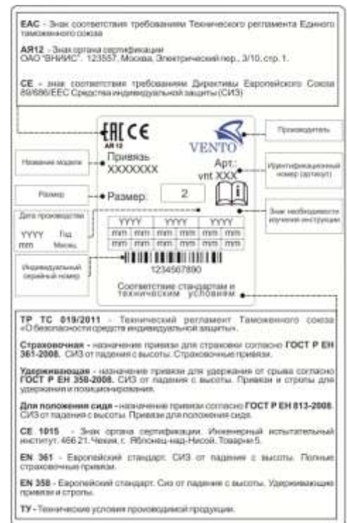
Рис. 1. Пример маркировки привязей «VENTO» и расшифровка значений.
