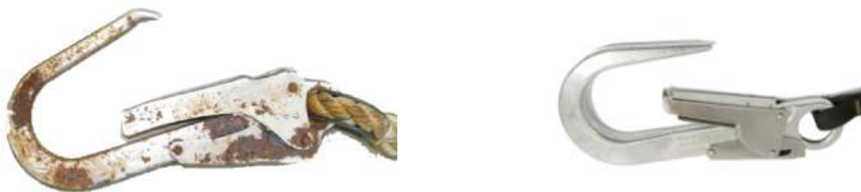
Рис. 66. Пример дефектов соединительных звеньев: чрезмерная выработка, деформация запирающего механизма, коррозия, отсутствие возвратной пружины защелки
