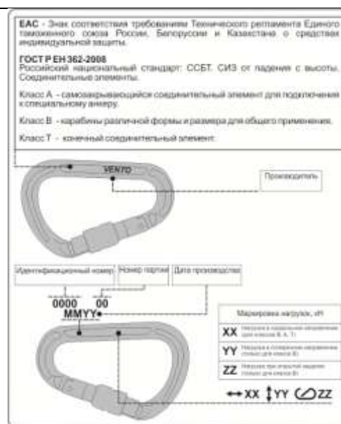
Рис. 63. Расшифровка маркировки карабинов VENTO
