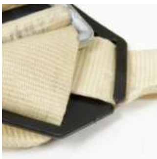
Рис. 24. Трещина на пластиковом переgone (требуется замена)
