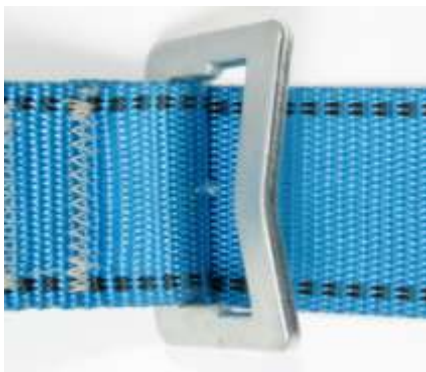
Рис. 19. Деформированная регулировочная пряжка
