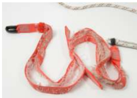
Рис. 27. Пример сшитого амортизатора после остановки падения.
