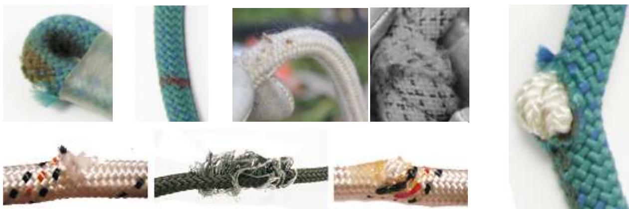
Рис. 55. Пример потертостей, химических, термических и механических повреждений каната, при которых требуется выбраковка изделия.
