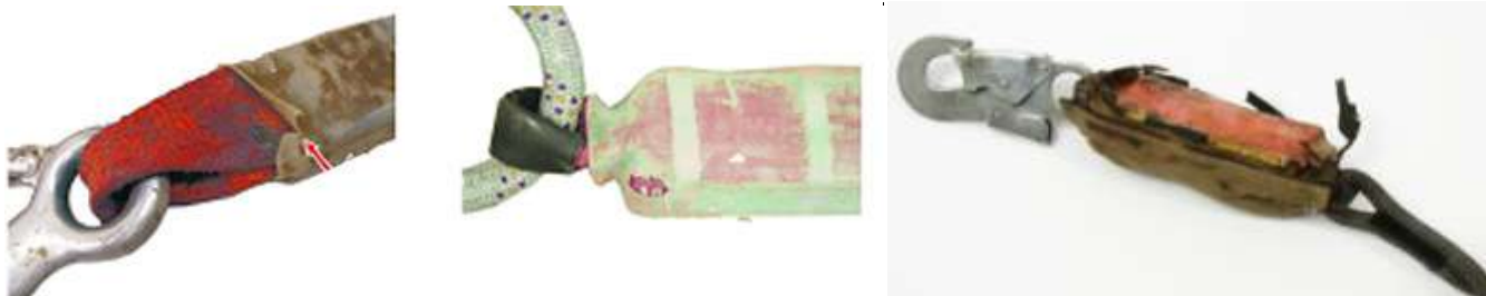
Рис. 29. Нарушение защитной оболочки амортизатора рывка
