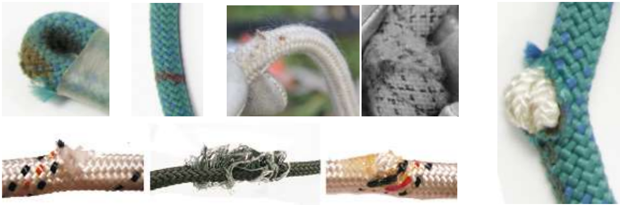
Рис. 42. Пример потертостей, химических, термических и механических повреждений каната, при которых требуется выбраковка изделия.
