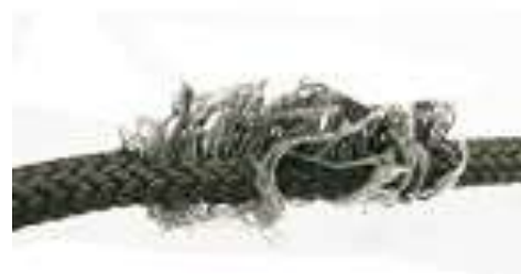
Рис. 37. Швы имеющие критические повреждения
