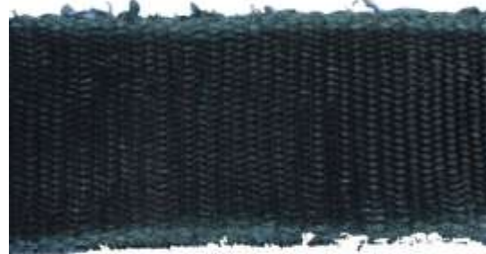
Рис. 5. Пример ленты с потертостями и надрывами краев.
