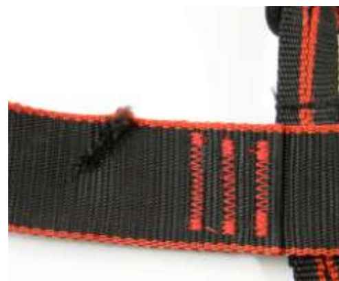
Рис. 4. Пример пореза ленты.
