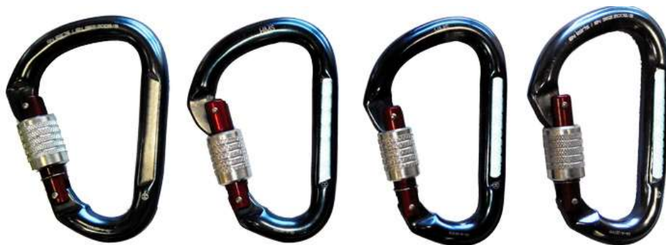
Рис. 30. Новый карабин и последовавшая под нагрузкой деформация.
