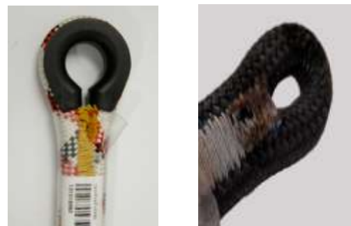
Рис. 58. Концевые зашивки, имеющие механические и термические повреждения
