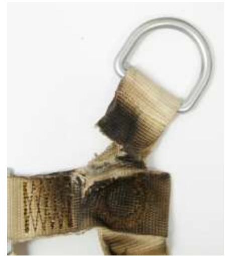
Рис. 6. Пример ленты, подвергшейся тепловому воздействию.
