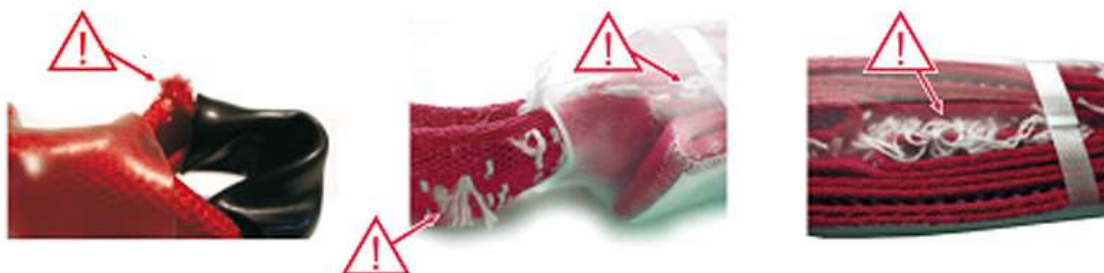
Рис. 53. Амортизаторы со следами дефектов
