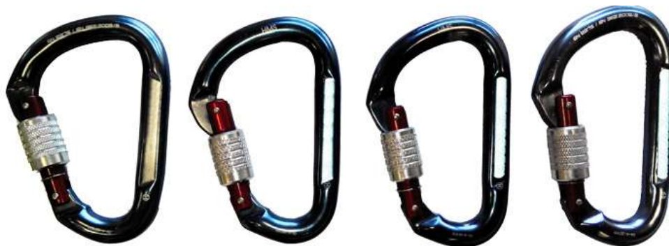
Рис. 60. Новый карабин и последовавшая под нагрузкой деформация.
