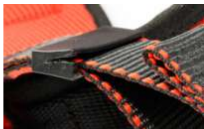
Рис. 24. Повреждение пластиковой шлевки для фиксации концов ленты
