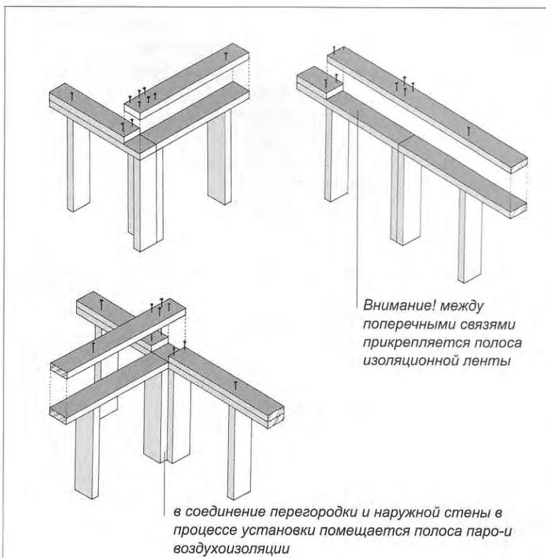
Рис. 44 г В соединениях стен соседние стойки прибивают гвоздями друг к другу. Между ними прокладывается уплотнительная лента.
