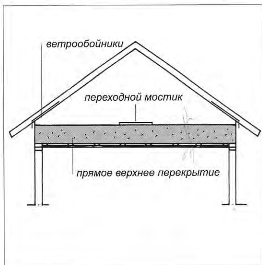
Рис. 99 а и б Нагнетаемая изоляция в перекрытиях решетчатого и балочного типа.
