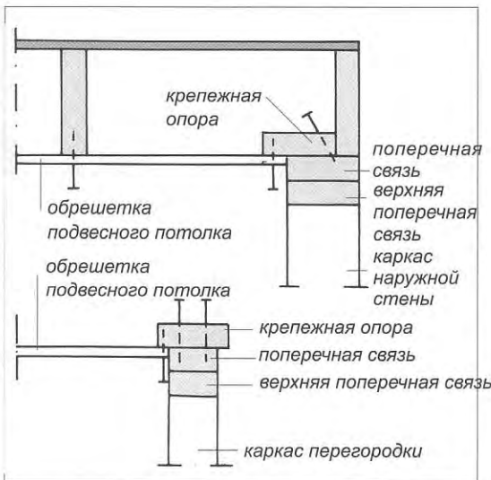
Рис. 38 б Крепление крепежных опор обрешетки потолка к поперечным связям в стенах параллельно балкам.
