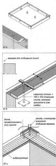
Рис. 47 а, б и в Крепление поперечных связей к фундаменту. Место для здания тщательно гидроизолируется и проверяются перекрестные размеры. На поперечных связях тщательно отмечаются места отверстий для штыря. Под поперечные связи укладывается гидроизоляция.
